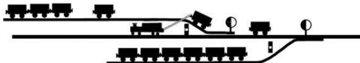
Slika 1b: Premaknitev vozila, kadar je prost le en tir. Vozilo se prestavlja z ene strani postaje na drugo.
