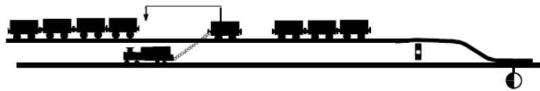
Slika 1a: Premaknitev vagona po istem tiru, kadar lokomotiva pelje po sosednjem tiru.
