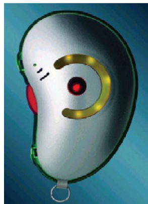
Slika 5 – Elektronski kazalnik hrupa, ki utripa pri preseganju ravni hrupa, kot jih predhodno naravnamo
